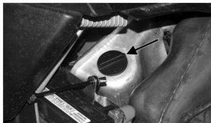
3. Insérez le bâton de niveau d'huile dans le réservoir d'huile sans l'embobiner et le retirer. Lisez le niveau d'huile paraissant sur le bâton. Le niveau d'huile devrait être près du milieu ou à l'extrémité supérieure de la gamme «NORMAL» du bâton.
